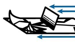
4 Через час после нанесения необходимо прогреть все наклейки строительным феном при температуре 80-90°C.
